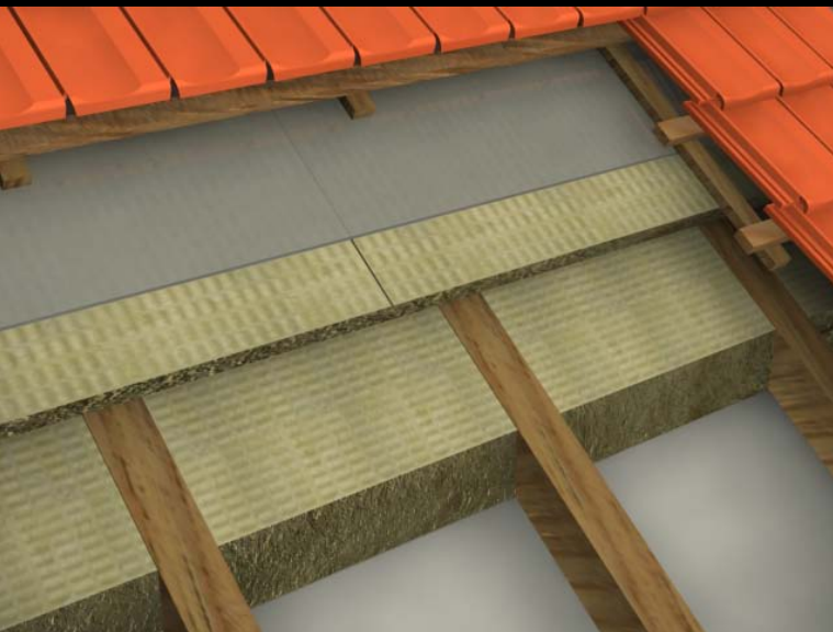
Pojačana toplotna izolacija krova i poda
